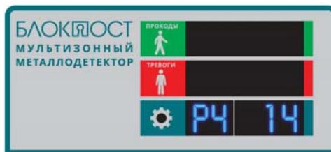
После выбора значения «РЧ» необходимо металлодетектор перезагрузить клавишей «7» - «ВКЛ/ВЫКЛ», металлодетектор пройдёт самодиагностику и перейдёт в рабочий режим.
