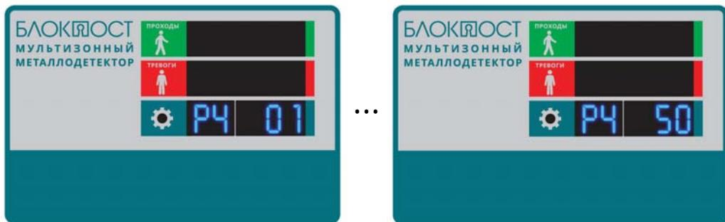
Рабочая частота позволяет одновременно работать нескольким металлодетекторам, для первого и каждого последующего детектора необходимо выбрать соответствующую рабочую частоту, чтобы исключить взаимовлияние друг на друга, а также выбор рабочей частоты будет влиять на устойчивую работу изделия.
