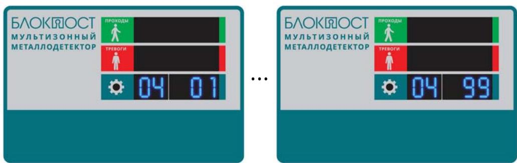
Уровень безопасности, дополнительно регулирует общую чувствительность всех зон обнаружения, в том числе и зону контроля по центру.
