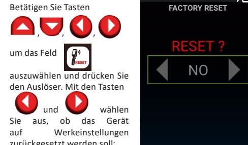
um das Feld auszuwählen und drücken Sie den Auslöser. Mit den Tasten und wählen Sie aus, ob das Gerät auf Werkseinstellungen zurückgesetzt werden soll:
